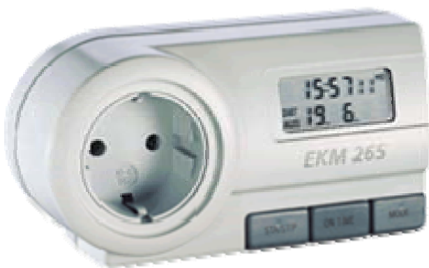
číslicový wattmetr EKM 265 obr. 21.5
