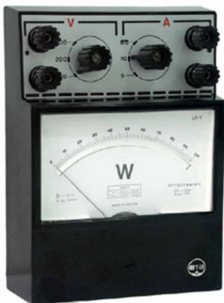
analogový wattmetr LW 1 obr. 21.3
